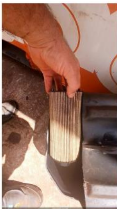
FOTO DO FILTRO DE COMBUSTÍVEL VELHO
