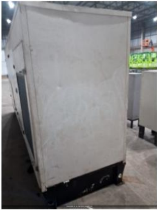
SE SIM, DETALHAMENTO ARRANHÕES POR TODA A PARTE EXTERNA E UMA DAS PORTAS COM O GANCHO DA FECHADURA QUEBRADO
